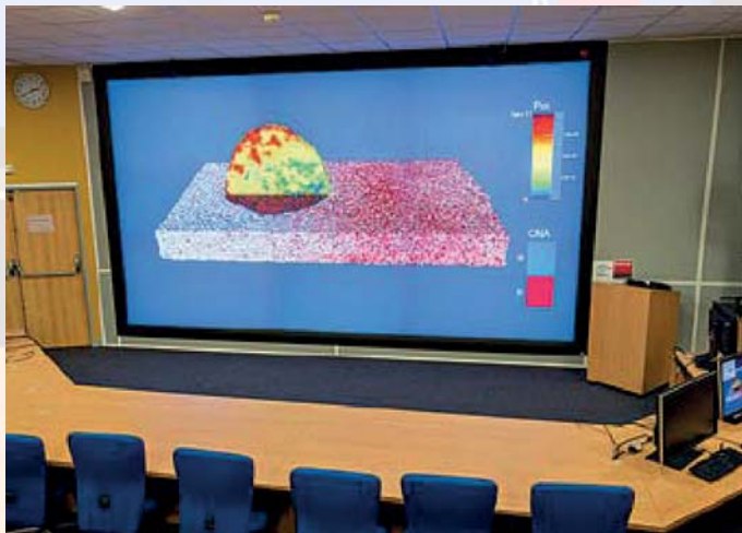
La salle Mirage et le mur d'images. À l'écran, résultat d'un calcul simulant la transition graphite/diamant dans une inclusion de carbone immergée dans une matrice de cuivre soumise à un choc.
