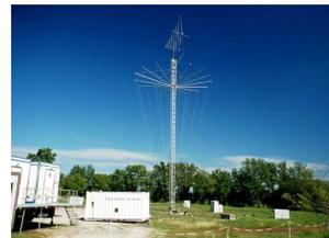
Antenne large bande pour tests électromagnétiques
