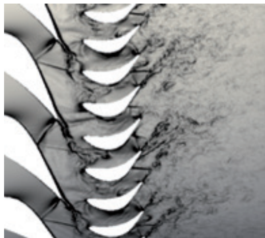
Figure 5 : Gradient de densité à 50% de hauteur de vane - Zoom autour de la roue HP.
